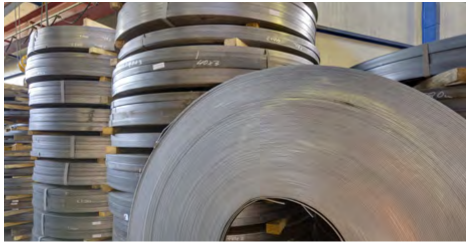
Οι Λάμες σε ταινία (strips) μπορούν να παραχθούν σε πλάτος από 16 mm και πάχος από 1,8 mm έως 5 mm.
